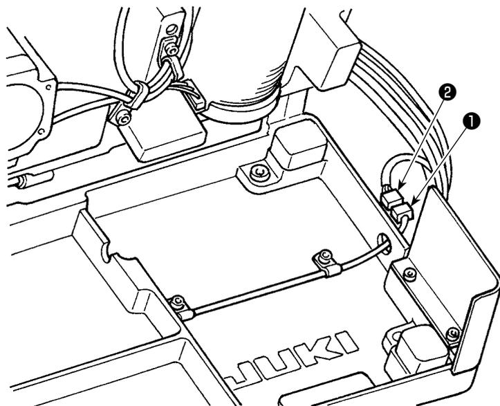
Conecte o detector do cabeçote da máquina 1 com o conector 2 localizado no lado do cabeçote da máquina.
