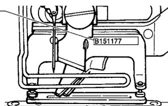
\* Defina o tipo 5 quando usar um calcador diferente dos tipos de 1 a 3. Altere a largura do tamanho do calcador **U015** e o comprimento do tamanho do calcador **U016** do interruptor de memória (nível 1) de acordo com o calcador que usará.
