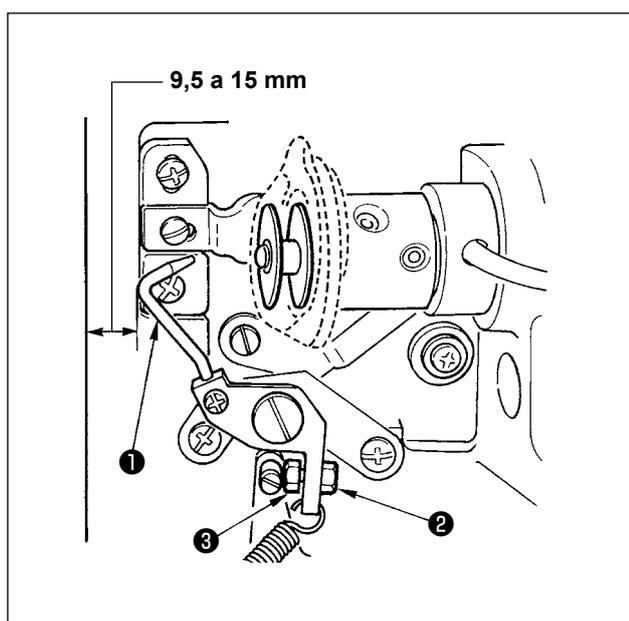
Afrouxe a porca 1 e ajuste a posição com a mola retentora 2 de forma que a distância desde a extremidade frontal da base da máquina até o prensador da bobina 3 fique de 9,5 a 15 mm quando a máquina de costura parar. Em seguida, aperte a porca 2.
