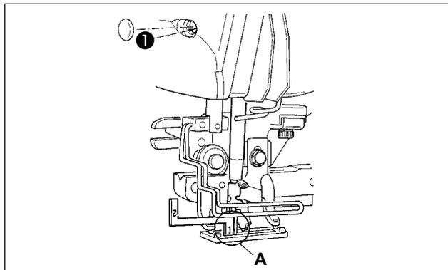
Ajuste a relação agulha-lançadeira quando a agulha entrar no centro do orifício da agulha na chapa de ponto.
