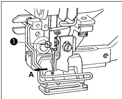
Segure a agulha com sua parte côncava virada para o lado **A** do operador, insira a agulha completamente no orifício de sujeição de agulha e, em seguida, aperte o parafuso de fixação da agulha 1 . Use uma agulha DPx5 (#11J, #14J).
