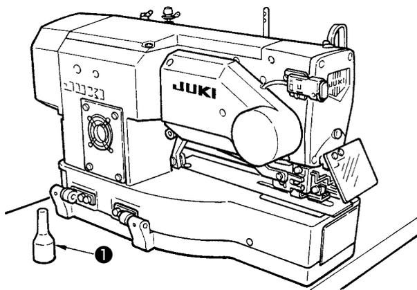
Quando inclinar o cabeçote da máquina de costura, incline a máquina de costura cuidadosamente até que a barra de suporte do cabeçote ❶ entre em contato com a máquina de costura.
