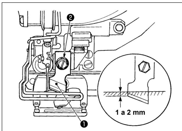
Quando substituir a faca por uma nova, proceda como segue.
