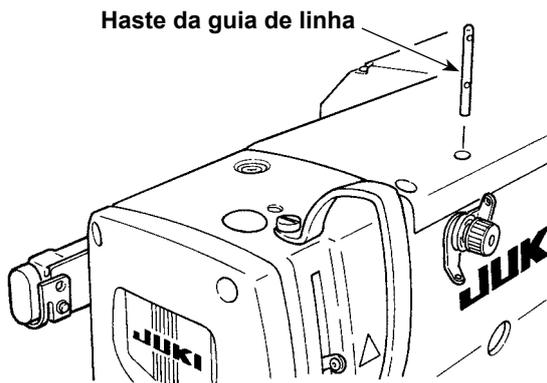
Ajuste a haste da guia de linha firmemente de forma que os dois orifícios laterais na haste da guia de linha fiquem virados para a guia de linha.
