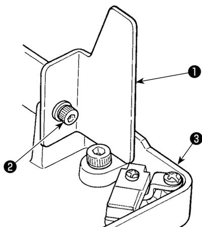
Instale a placa de blindagem de óleo da lançadeira 1 na base de assentamento 3 com o parafuso de fixação 2.
