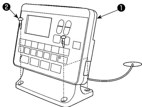
Fixe o painel de operação 1 na mesa com os quatro parafusos para madeira 2. Passe o cabo através do orifício 3 na mesa.
